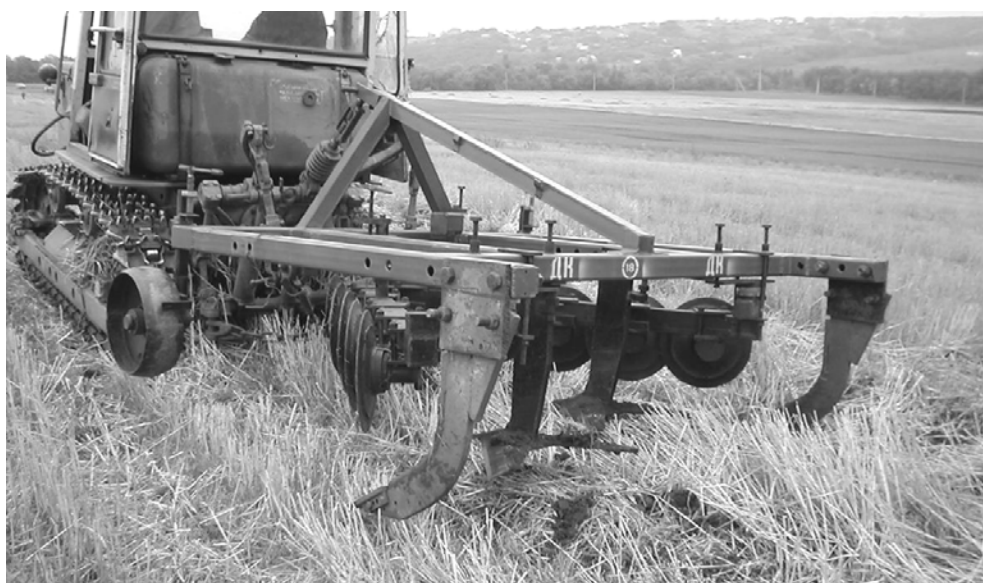
Рисунок 1. Орудие противоэрозийное ОПЩ-3С с щелерезами
